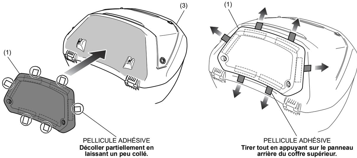
3. Appliquer une pression adéquate de 50 N (5 kgf) sur le panneau arrière du coffre supérieur fixé, puis relâcher la pression adéquate et laisser le panneau arrière du coffre supérieur pendant 10 minutes pour stabiliser l'ajustement de la surface adhésive.
